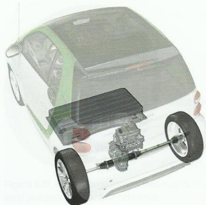
Figura 6.23. Componentes de la transmisión del Smart (fuente Smart).
