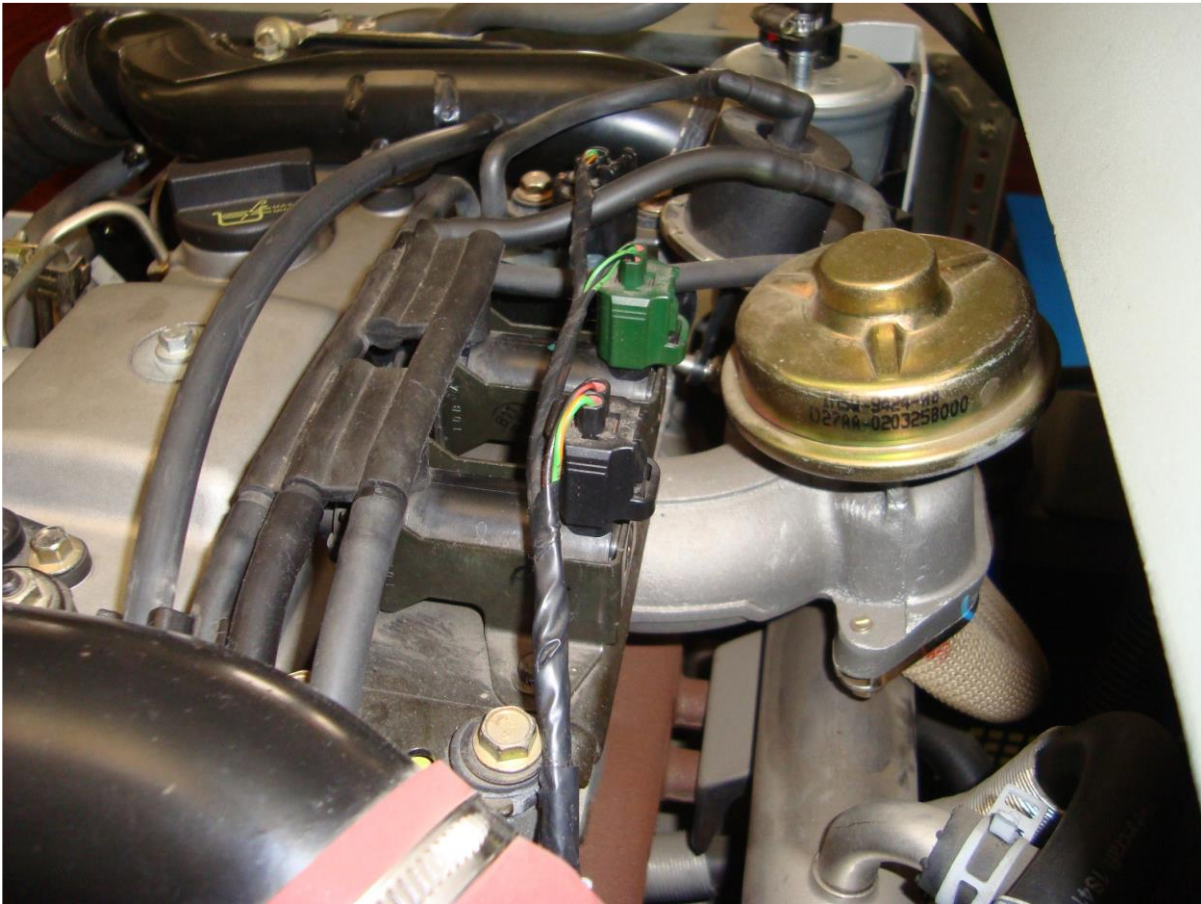
Válvula EGR de accionamiento electro-neumático
